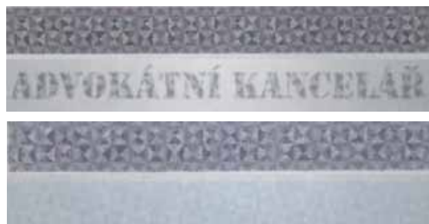
Obr.: V horní části originál (ve viditelném světle – sít' bodů a v infračerveném záření – text ADVOKÁTNÍ KANCELÁŘ) a v dolní části kopie (ve viditelném světle – sít' bodů a v infračerveném záření žádný skrytý text).
